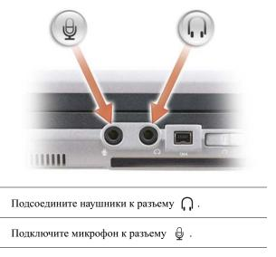
**РАЗЪЕМ IEEE 1394** — Служит для подключения устройств, поддерживающих высокоскоростную передачу данных по стандарту IEEE 1394 (например, цифровых видеокамер).
