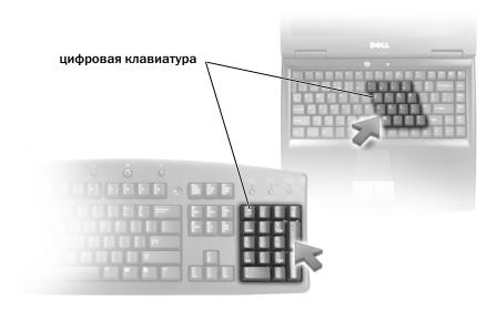
Встроенная цифровая клавиатура работает так же, как и внешняя цифровая клавиатура. Каждая клавиша выполняет несколько функций. Цифры и символы клавиатуры указаны синим цветом на правой части клавиш клавиатуры. Чтобы ввести цифру или символ, нажмите и не отпускайте клавишу <Fn>, а затем нажмите требуемую клавишу.
