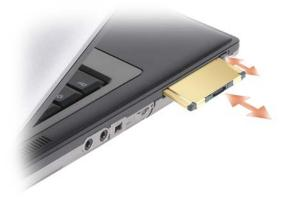
Компьютер распознает большинство плат PC Card и автоматически загружает необходимые драйверы. Если программа настройки выдаст запрос на загрузку драйверов производителя, используйте гибкий диск или компакт-диск, которые прилагаются к плате PC Card.
