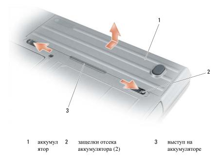
Для повторной установки аккумулятора выполните процедуру извлечения в обратном порядке.
