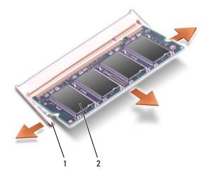
фиксаторы (по 2 на разъем)
